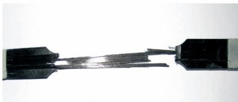
図4 試験後の試験体（繊維単体）
