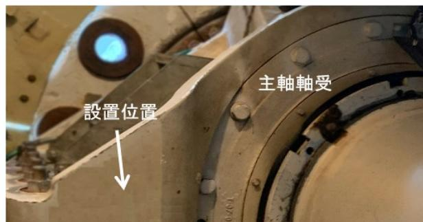
図2 A E センサ設置位置（主軸軸受）
